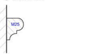
15 STRINGER BEADING PROFILE Scale: Actual Size
